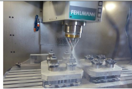
**Staubfrei im Drei-Schicht-Betrieb:** Die Abdichtung von Führungen und Kugelumlaufspindeln war für Fehlmann nicht neu, die Absaugung hat man entsprechend angepasst. (© Fehlmann/Polenz)
